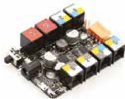
La platine "Me orion baseBoard" est architecturée sur un coeur compatible arduino UNO associé à un contrôleur de moteur spécialisé de type "TB6612", lequel sera directement capable de piloter 2 moteurs "cc" (6 à 12 V / 1 A max.).
