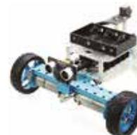
Le robot peut être assemblé en base 2 roues + 1 roue folle ou en base avec des chenilles
