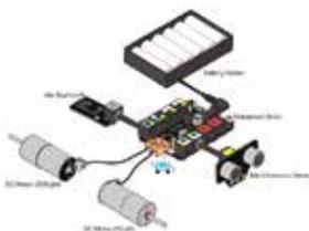
Ces prises reprennent les principaux signaux en provenance du microcontrôleur ATmega328 afin que vous puissiez y raccorder instantanément (et sans opération de soudure) une multitude de petits modules d'extensions à l'aide de câbles dédiés.
