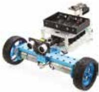
Le robot peut être assemblé en base 2 roues + 1 roue folle ou en base avec des chenilles
